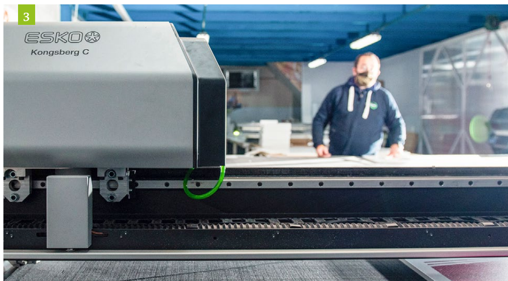
3) Taglio dei materiali con plotter piano Kongsberg C64. 4) Cucitura del tessuto. 5) Realizzazione di un cassonetto retroilluminato con stampa in tessuto.
